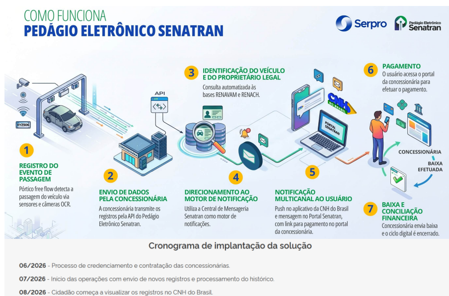
Figura 22 – Sistemática de Informação das Passagens por Pórticos de free flow no Aplicativo da CNH do Brasil
